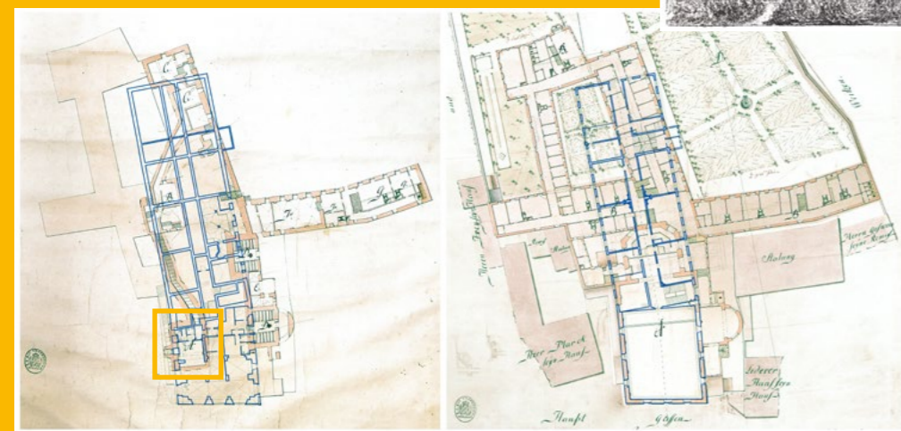
Aufmaß des Franziskanerklosters von 1802, überlagert mit dem aktuellen Bestand (blau). Links das Untergeschoss mit dem aus dem Erstbestand übernommenen Kellerraum, rechts das Obergeschoss (Abbildung: Stadtarchiv Freising, Plansammlung / Aufmaß und Überlagerung: kb-bm)
